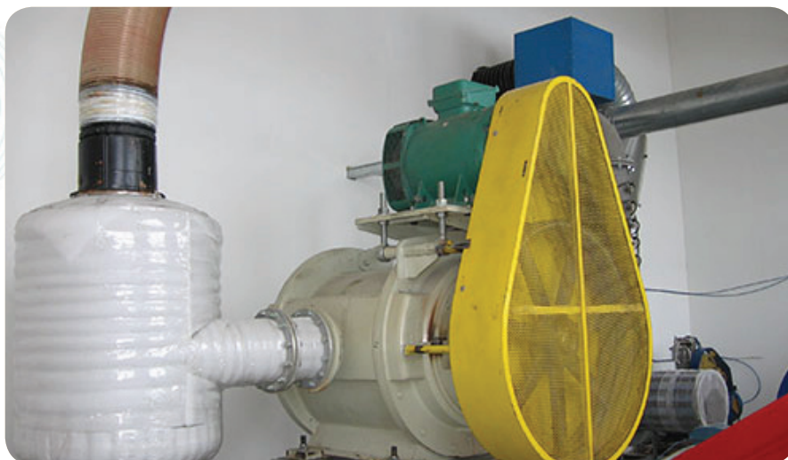
Вакуум создается специальным насосом, таким большим, что он категорически не помещался целиком в объективе нашей цифромьльницы. Поэтому покажем его по частям. В этом цилиндре двигатель мощностью 160 киловатт создает вакуум.
