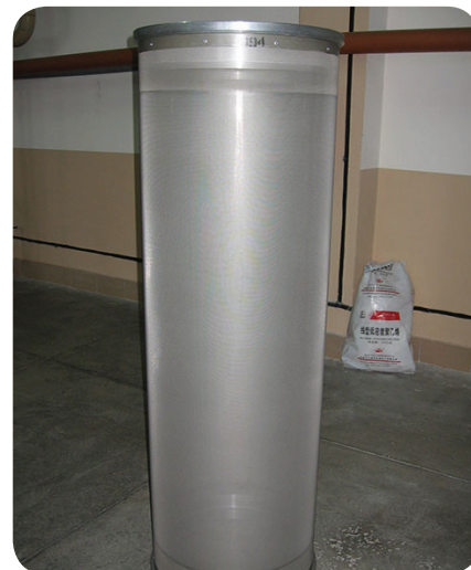
А это барабан, при помощи которого получается перфорация.
